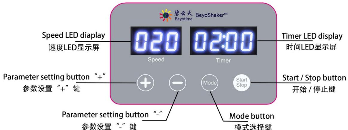
图1. BeyoShaker™数字式翘板摇床(E6673)的操作面板示意图。
